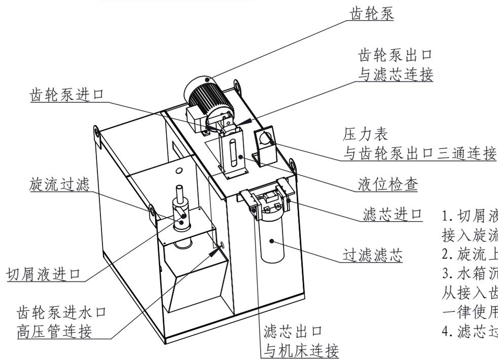
1. 切屑液从水箱通过水泵连接接入旋流过滤入口
